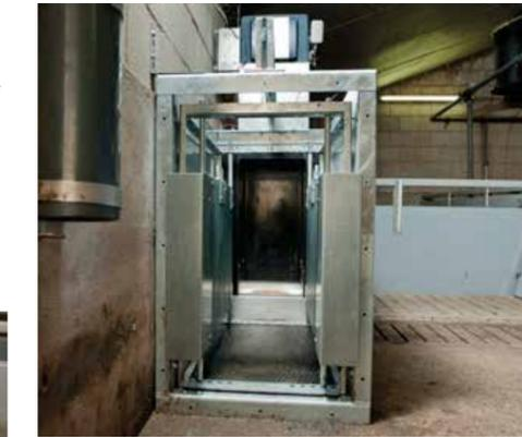
est muni d'un système de dosage d'aliments d'une précision de 98 %. La fiabilité de la pesée des aliments est de 99 % et l'écart maximal du poids enregistré d'1 kilogramme. Le système détermine lui-même la densité volumique de l'aliment. Dès que la trémie d'alimentation est vide, le système s'arrête et une alarme se déclenche.
